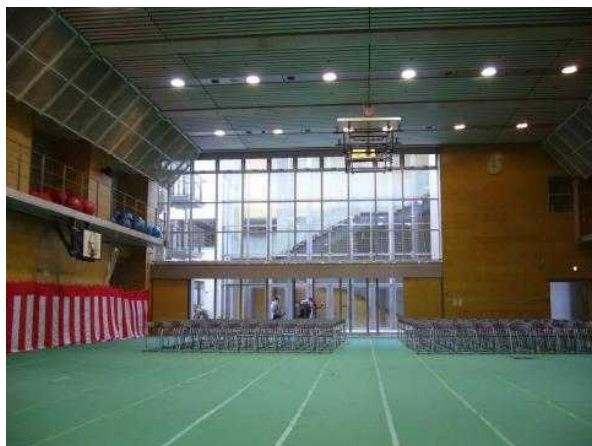
新たに増築された地下体育館。 サンクンガーデンから光が入るよう設計された。
